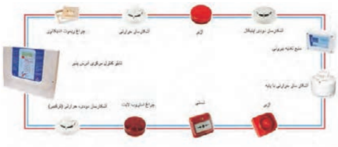
شکل ۱-۲ سیستم اعلام حریق آدرس پذیر
